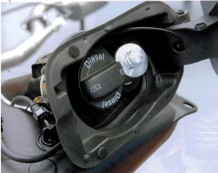
Bij veel auto's wordt AdBlue bijgevuld via een dop die zich naast de vuldop van de brandstof bevindt. Bij andere zit de vuldop onder de motorkap.
